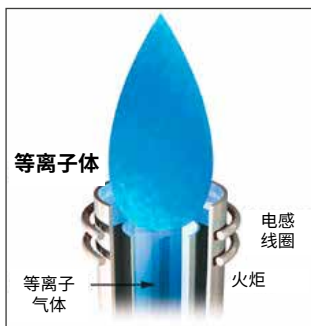
图 21: ICP 示意图。 来源: Noria Corp
