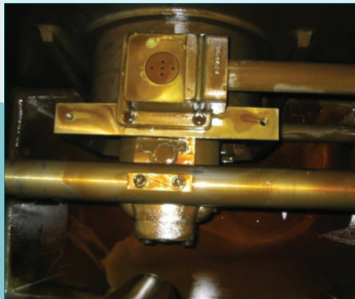
Exemple de formation de vernis sur un boîtier de direction
