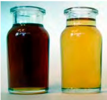
Figura 12: Aceite hidráulico degradado comparado con aceite nuevo Fuente: C.C. JENSEN A/S
