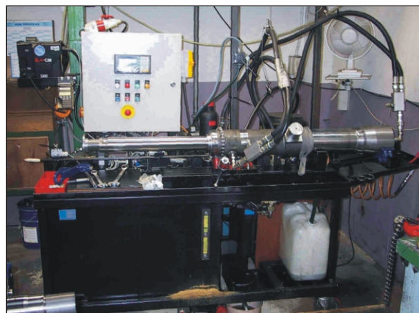
Lind Jensens Maskinfabrik har i samarbejde med C.C.JENSEN udviklet et antal testbænke som på samme tid kan rense og teste hydraulikcylindre.
