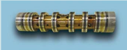
Formazione di morchie nel cilindro di regolazione di un distributore
