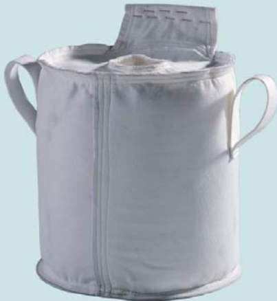
Cartuccia filtrante chimica CJC Ripieno: Setaccio molecolare, ossido di alluminio, terra da sbianca, resina scambiatrice di ioni Applicazione: Fluidi HFD, trasformatori
