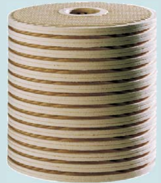
Cartuccia BLA di filtrazione fine CJC Oli minerali contenenti acqua e fluidi sintetici idraulici e di lubrificazione fino a ISO VG 460 / 40°C, inoltre fluidi HFC e HFA
