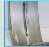
Formazione di rigature a causa dell'abrasione ( Guscio di cuscinetto )
