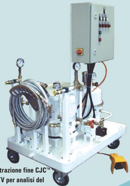
CJC™ Desorber D 40 - per la rimozione di grandi quantità d'acqua dei fluidi
