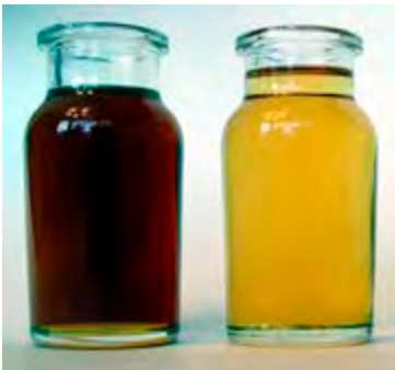
Figur 12: Nedbrudt hydraulikolie sammenlignet med ny olie Kilde: C.C.JENSEN A/S
