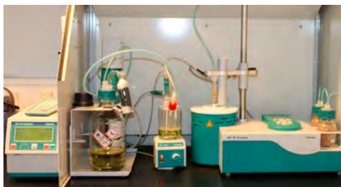
Figur 19: Udstyr anvendt til den indirekte Karl Fisher-metode
