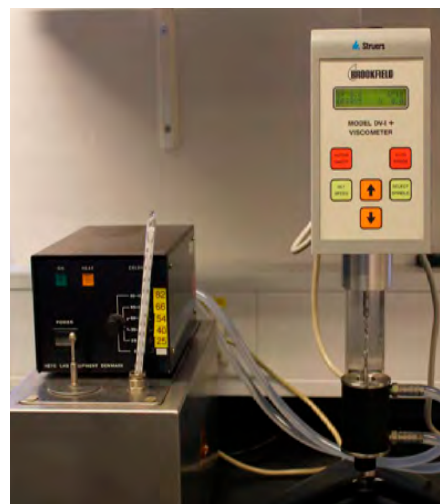
Figur 13: Viskosimeter måler kinematisk viskositet (cSt)
