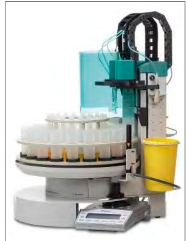
Figur 20: Udstyr til test af syreniveau
