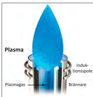
Figur 21: Illustration av ICP. Källa: Noria Corp
