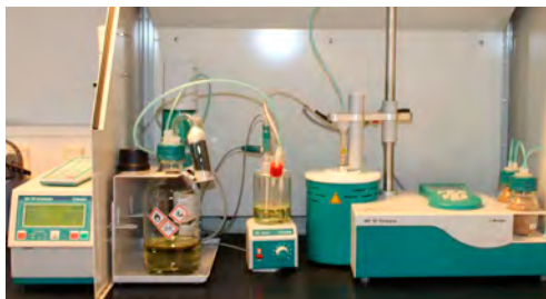
Figur 19: Utrustning som används för den indirekta Karl Fisher-metoden
