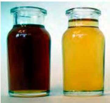
Figur 12: Nedbruten hydraulolja jämfört med ny olja Källa: C.C.JENSEN A/S
